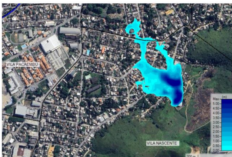
Figura 26 – Mancha de inundação estimada do reservatório 2.
